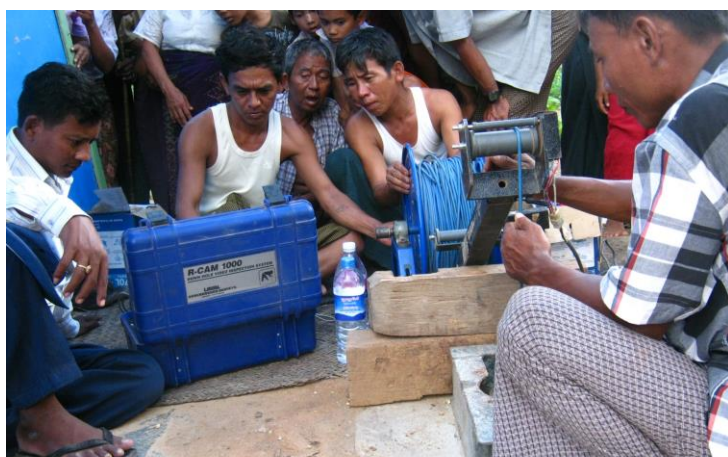
写真 9 ポアホールカメラで孔内を確認
